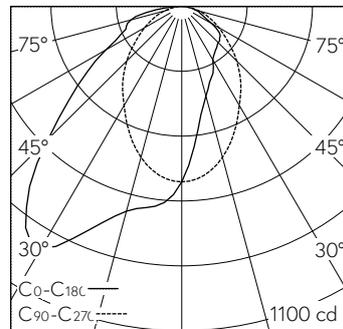
LED 4000 K 14 W 1500 lm-h / CIE Flux 51 81 95 100 100 / A40 selon DIN 5040
