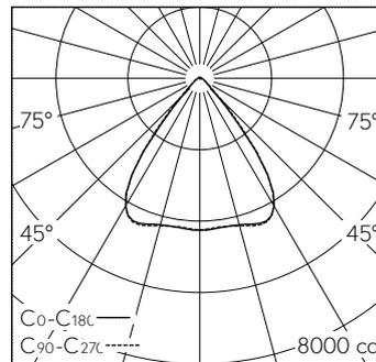
LED 4000 K 47 W 6900 lm-h / CIE Flux 85 96 99 98 100 / A71 selon DIN 5040
