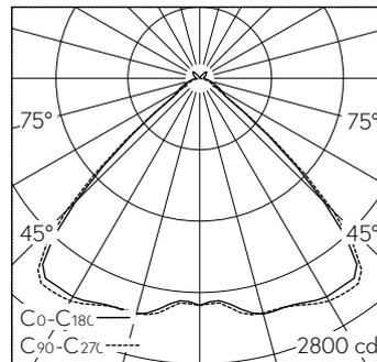
LED 4000 K 39 W 5800 lm-h / CIE Flux 69 95 99 98 100 / A62 selon DIN 5040
