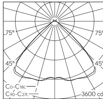
LED 4000 K 47 W 6900 lm-h / CIE Flux 69 95 99 98 100 / A62 selon DIN 5040
