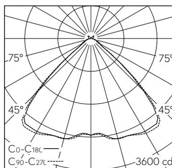
LED 4000 K 47 W 6900 lm-h / CIE Flux 69 95 99 98 100 / A62 selon DIN 5040
