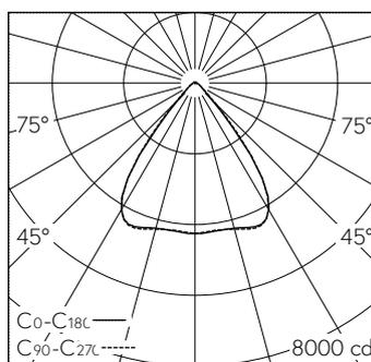
LED 4000 K 47 W 6900 lm-h / CIE Flux 85 96 99 98 100 / A71 selon DIN 5040
