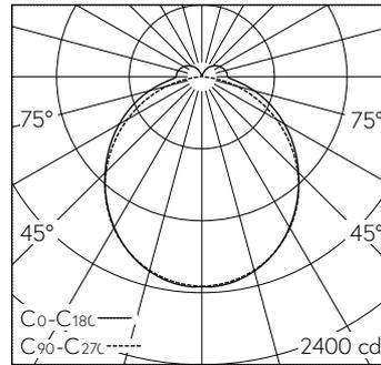
LED 4000 K 39 W 5700 lm-h / CIE Flux 46 76 93 90 100 / A41 selon DIN 5040
