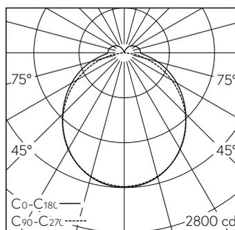
LED 4000 K 47 W 6800 lm-h / CIE Flux 46 76 93 90 100 / A41 selon DIN 5040
