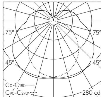
LED 4000 K 9 W 1089 lm-h / CIE Flux 37 66 86 77 100 / B31 selon DIN 5040
