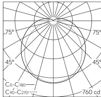
LED 4000 K 19 W 2276 lm-h 130°/110° / CIE Flux 42 71 89 92 100 / A31 selon DIN 5...
