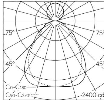
4 x LED 3000 K 48 W 5932 lm-h / CIE Flux 61 85 96 74 100 / B53 selon DIN 5040
