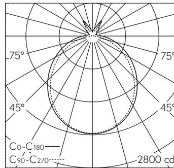
LED 4000 K 47 W 6584 lm-h / CIE Flux 47 77 93 87 100 / B43 selon DIN 5040
