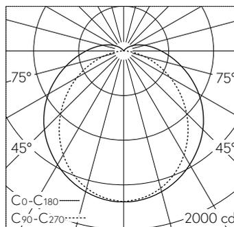
LED 4000 K 41 W 6022 lm-h 132°/102° / CIE Flux 42 71 89 91 100 / A31 selon DIN 5...
