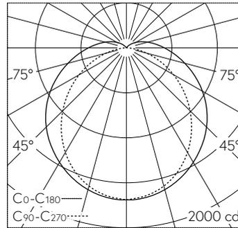
LED 4000 K 41 W 6022 lm-h / CIE Flux 42 71 89 91 100 / A31 selon DIN 5040
