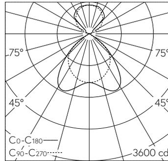
LED 4000 K 41 W 5040 lm-h / CIE Flux 71 99 100 63 100 / B64 selon DIN 5040
