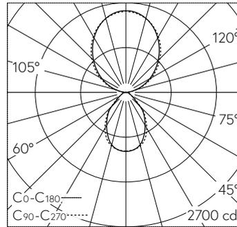
LED 4 x 4000 K 42 W 5951 lm-h / CIE Flux 69 91 98 32 100 / D63 selon DIN 5040
