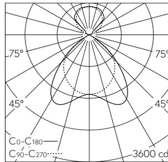
LED 4000 K 47 W 5703 lm-h / CIE Flux 71 99 100 68 100 / B64 selon DIN 5040
