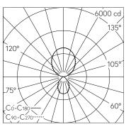
LED 5 x 4000 K 64 W 8565 lm-h / CIE Flux 69 91 98 28 100 / D63 selon DIN 5040
