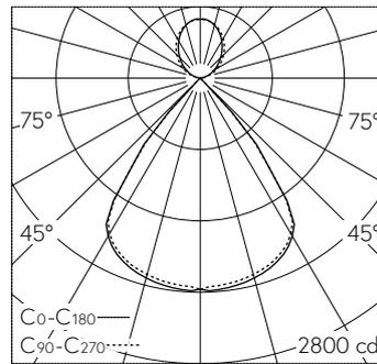
LED 3000 K 30 W 4094 lm-h / CIE Flux 94 100 100 68 100 / B83 selon DIN 5040
