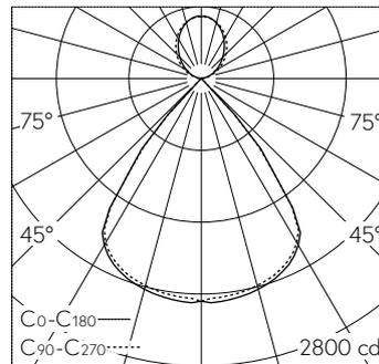
LED 4000 K 30 W 4289 lm-h / CIE Flux 94 100 100 68 100 / B83 selon DIN 5040
