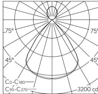
LED 3000 K 35 W 4698 lm-h / CIE Flux 94 100 100 73 100 / B83 selon DIN 5040
