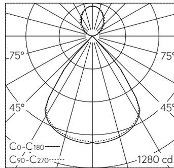
LED 3000 K 15 W 2047 lm-h / CIE Flux 94 100 100 68 100 / B83 selon DIN 5040
