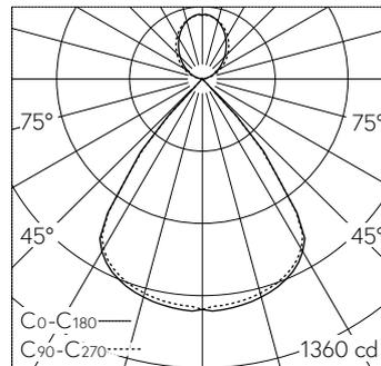
LED 4000 K 15 W 2145 lm-h / CIE Flux 94 100 100 68 100 / B83 selon DIN 5040
