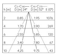
LED 4000 K 16,5 W 2045 lm-h 24°/52° / CIE Flux 98 100 100 100 100 / A80 nach DI...
