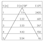
LED 3000 K 16,5 W 1821 lm-h 58° / CIE Flux 99 100 100 100 100 / A80 nach DIN 5040
