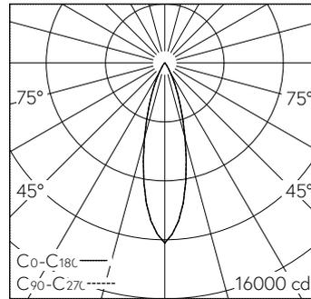
LED 3000 K 37 W 3470 lm-h / CIE Flux 99 100 100 99 100 / A81 nach DIN 5040
