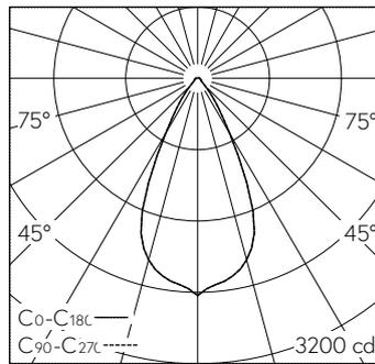
LED 33 W 1944 lm-h / CIE Flux 88 95 98 100 / A81 nach DIN 5040
