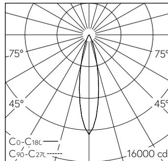
LED 3000 K 25 W 2560 lm-h / CIE Flux 99 100 100 99 100 / A81 nach DIN 5040
