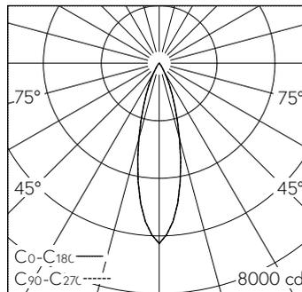
LED 3000 K 16,5 W 1779 lm-h / CIE Flux 99 100 100 99 100 / A81 nach DIN 5040
