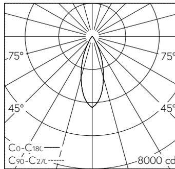
LED 33 W 1841 lm-h / CIE Flux 98 100 100 98 100 / A81 nach DIN 5040
