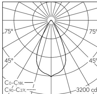
LED 33 W 1944 lm-h / CIE Flux 88 95 98 97 100 / A81 nach DIN 5040
