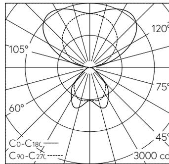
LED 4000 K 80 W 9418 lm-h / CIE Flux 63 89 97 28 100 / D63 nach DIN 5040
