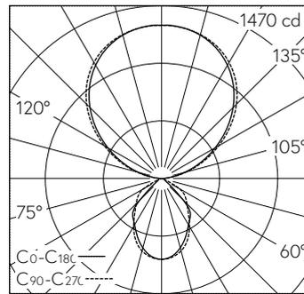
LED 3000 K 35,2 W 4857 lm-h / CIE Flux 66 92 98 24 100 / D63 nach DIN 5040
