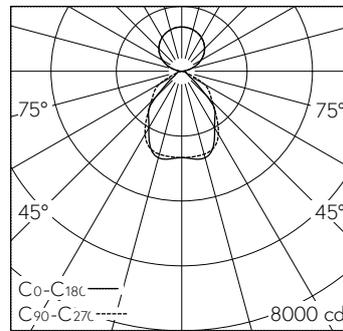
LED 4000 K 73 W 9446 lm-h / CIE Flux 65 91 98 56 100 / C63 nach DIN 5040
