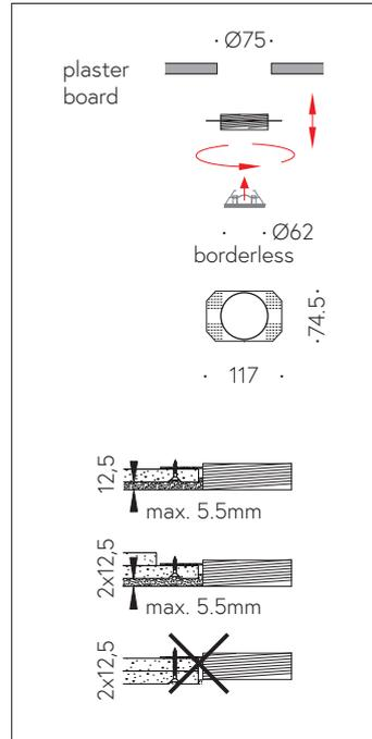
Für Montage bei abgehängten Decken
