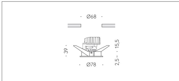
Schutzart IP54, staub- und spritzwassergeschützt
