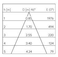
LED 3000 K 13,7 W 1202 lm-h  $46^{\circ}$  / CIE Flux 98 100 100 100 / A80 nach DIN 5040
