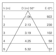
LED 2700 K 10 W 724 lm-h  $56^{\circ}$  / CIE Flux 95 100 100 100 100 / A80 nach DIN 5040
