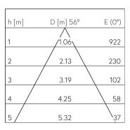
LED 2700 K 10 W 724 lm-h 56° / CIE Flux 95 100 100 100 100 / A80 nach DIN 5040
