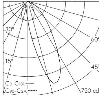
LED 4000 K 10 W 421 lm-h / CIE Flux 76 96 100 100 100 / A70 nach DIN 5040
