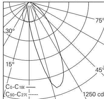
LED 3000 K 18,9 W 706 lm-h / CIE Flux 76 96 100 100 100 / A70 nach DIN 5040
