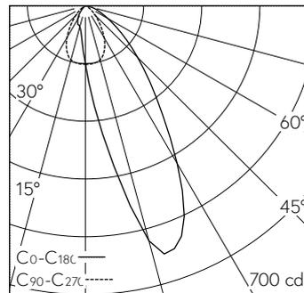
LED 2700 K 10 W 387 lm-h / CIE Flux 76 96 100 100 100 / A70 nach DIN 5040
