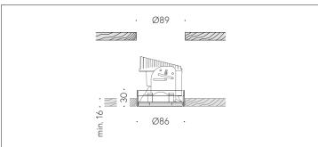
Edelstahl aussen partiell randiert. Rändelung für optimale Klebehaftung und 3 Madenschrauben zur Ausrich-tung bei Montage.
