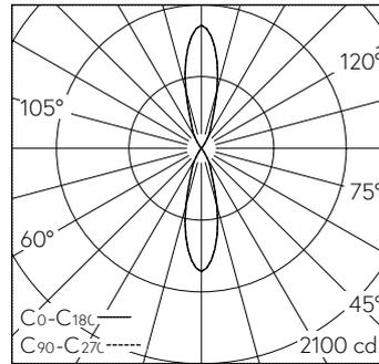
LED 4000 K 8,8 W 384 lm-h / CIE Flux 100 100 100 50 100 / C84 nach DIN 5040
