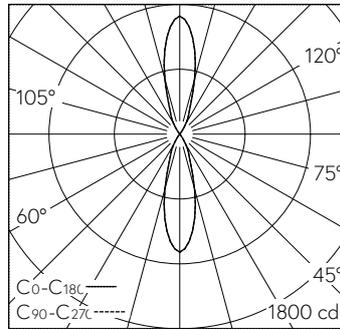
LED 3000 K 8,8 W 349 lm-h / CIE Flux 100 100 100 50 100 / C84 nach DIN 5040
