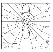
LED 4000 K 8,8 W 494 lm-h / CIE Flux 98 100 100 50 100 / C84 nach DIN 5040
