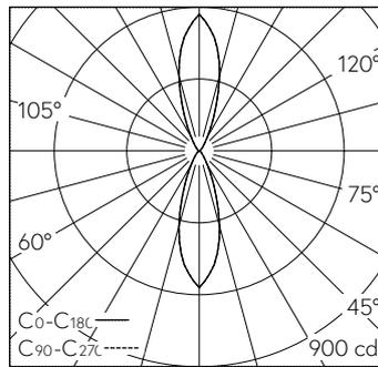
LED 4000 K 8,8 W 241 lm-h / CIE Flux 91 98 100 50 100 / C84 nach DIN 5040
