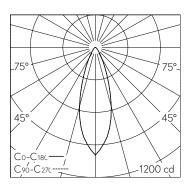
LED 3000 K 9,2 W 423 lm-h / CIE Flux 91 98 100 99 100 / A80 nach DIN 5040
