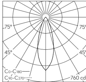
LED 8.9 W 266 lm-h / CIE Flux 91 98 100 99 100 / A80 nach DIN 5040
