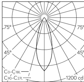
LED 3000 K 9,2 W 423 lm-h / CIE Flux 91 98 100 99 100 / A80 nach DIN 5040
